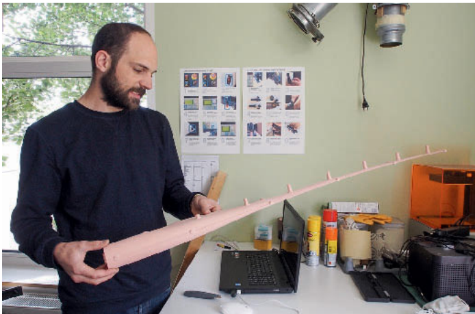
Die Kölner Tischler setzen nicht nur verschiedene Technologien, sondern auch diverse Werkstoffe ein. Im Formenbau kommen z. B. Hartschäume zum Einsatz.
