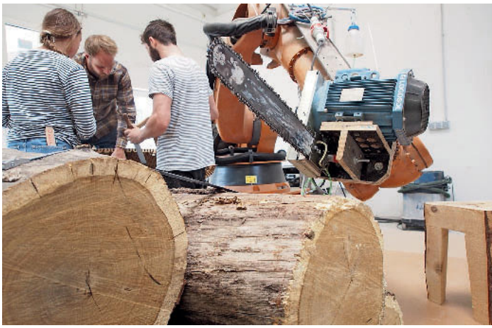
Der neueste Kollege aus dem Hause Kuka hat sieben Achsen und sägt – mit einer Kettensäge bestückt – den Hocker „7xstool“ aus massiven Holzstämmen.
