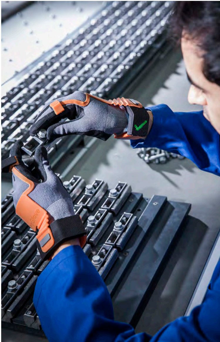
Abbildung 1: Der intelligente Handschuh von ProGlove im Einsatz. Er unterstützt die Mitarbeiter im Prozess der Montage oder Reparatur.
