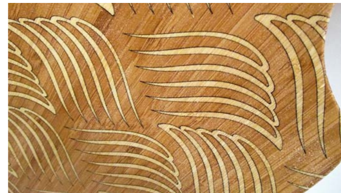
Jeder Azubi konnte sein ganz individuelles Longboard im CAD planen. Intarsien wie diese wurden dann per Laser hergestellt.
