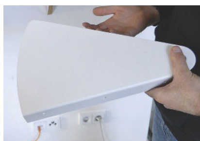
Warum nicht mal ein abgekantetes Blech statt MDF aus dem Vollen fräsen?
