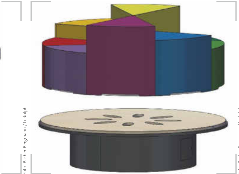
/ „Gendervitrine“: In der Teilexplosionszeichnung sind die Klimatisierungsöffnungen im Boden der Vitrine gut sichtbar dargestellt.
